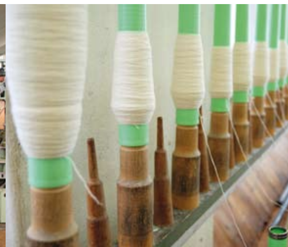
Verspinnen des Garns zu einem feinen Faden in der Ringspinnerei
