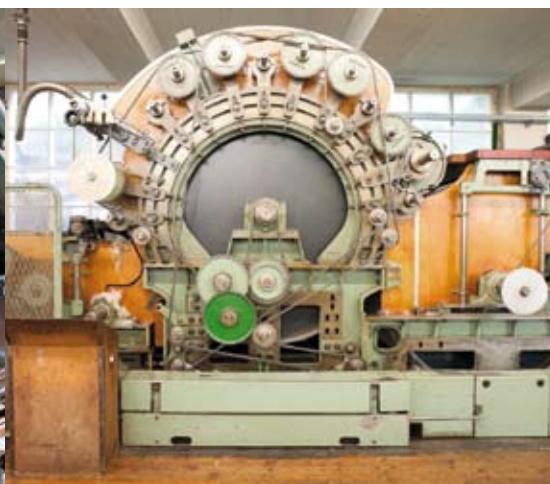
Der Krempel in voller Pracht: hier wird die Wolle zu einem feinen Vlies gekämmt
